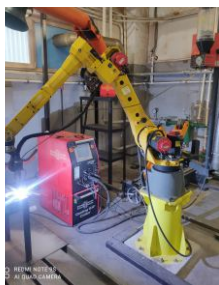
Роботизированная наливочная станция
